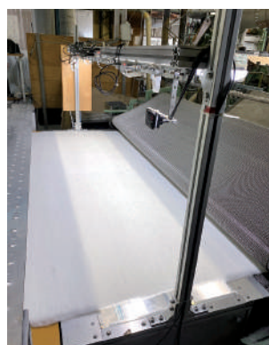
画像検査システム
