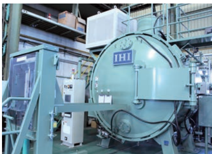
真空熱処理炉 現在、6基が稼働している
