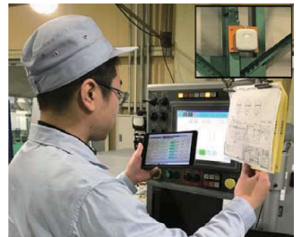
工場内で使用されるタブレットと無線LANのアクセスポイント
