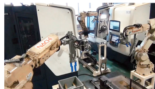
(事例1) 旋盤・円筒研削盤加工ロボット
